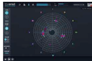
The Snail: analyseur spectral à alignement chromatique
